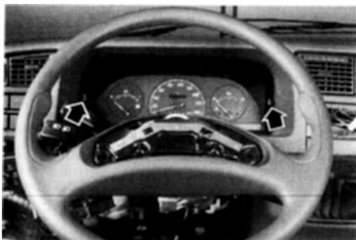
Vis de fixation du combiné d'instruments.
