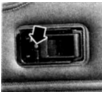
Vis de fixation de la poignée d'ouverture intérieure (visible après dépose de l'enjoliveur).
