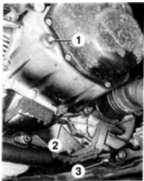
Implantation des bouchons de boîte de vitesses.
