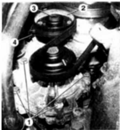
Pompe à eau. 1. Vis de fixation de la pompe à eau - 2. Galet tendeur de courroie de pompe à eau - 3. Écrou central du galet tendeur - 4. Vis de réglage du galet tendeur.
