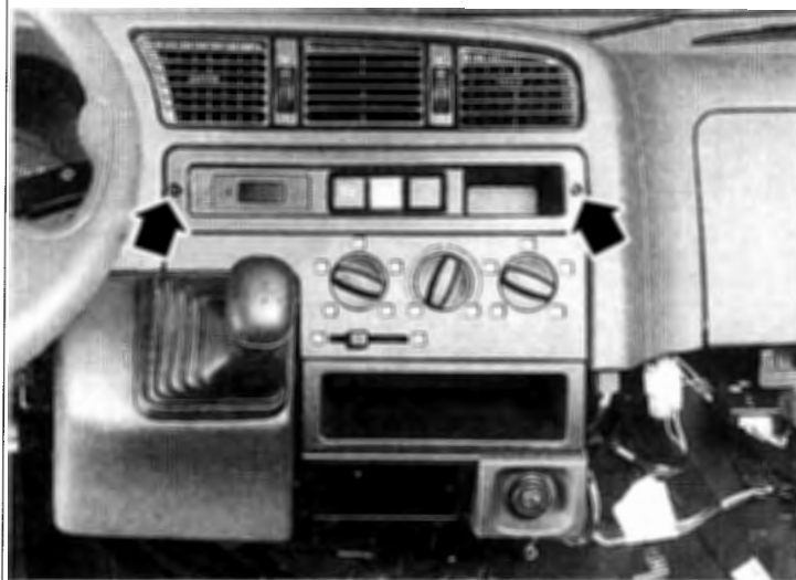
Vis de fixation du porte-interrupteurs central.
