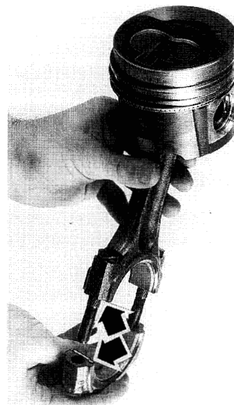
Assemblage bielle-piston. La chambre de turbulence sur la tête de piston doit se trouver du côté des ergots de coussinets de bielles (flèches).
