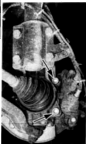
Vis de fixation d'un support d'étrier.
