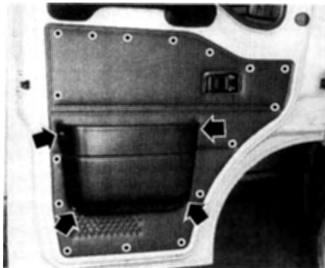
Vis de fixation du vide-poches sur la porte côté conducteur.
