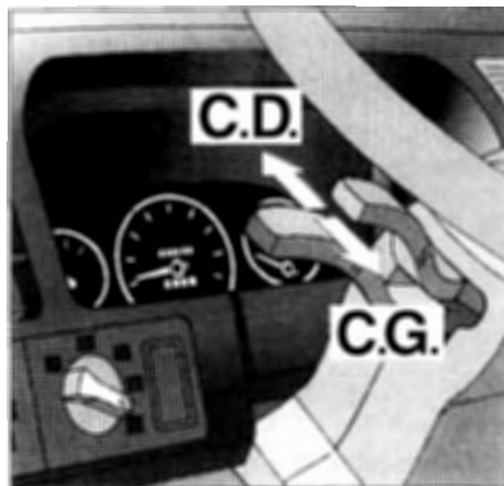
Commandes des clignotants C.D. droit - C.G. Gauche.
