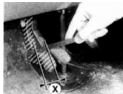
Mesure de la course de la pédale d'embrayage. X = 180 ± 3 mm.
