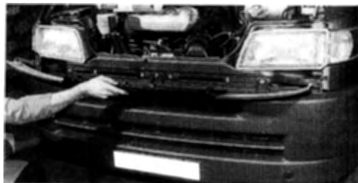
Repose de la grille de calandre. Veiller à insérer correctement les tétons de positionnement dans leurs orifices.
