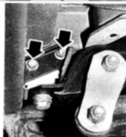
Fixations de la traverse arrière.
