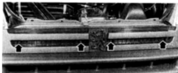
Vis de fixation de la grille de calandre.
