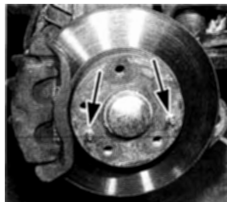
Vis de fixation du disque sur le moyeu.
