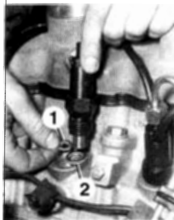
Repose d'un porte-injecteur. 1. Rondelle pare-feu (face bombée côté injecteur) - 2. Rondelle-joint en cuivre.
