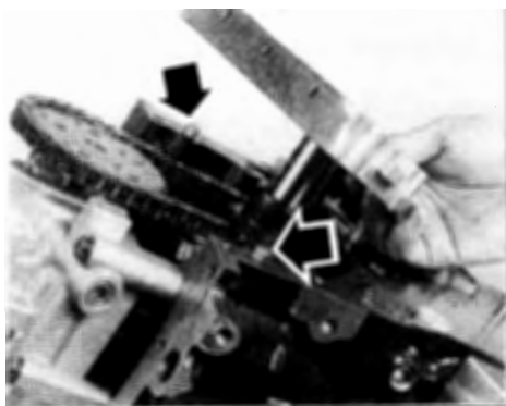
Lors de la repose de la plaque porte-joint, veiller à la présence des pions de centrage.
