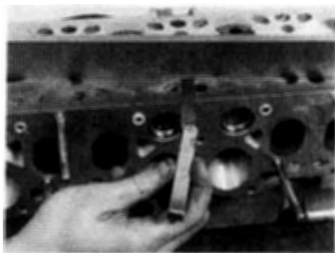
Contrôle de la planéité du plan de joint de culasse.
