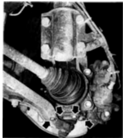
Vis de fixation d'une rotule inférieure sur un pivot.
